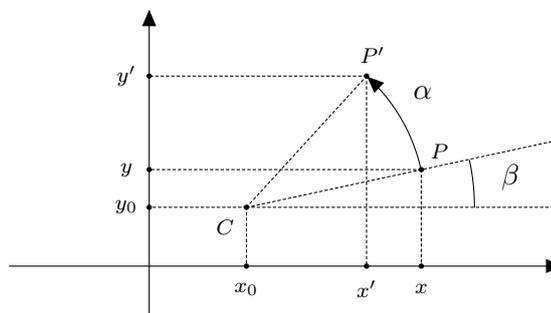
Figura 18 Rotazione di centro  $C = (x_0, y_0)$  e angolo  $\alpha$ .
