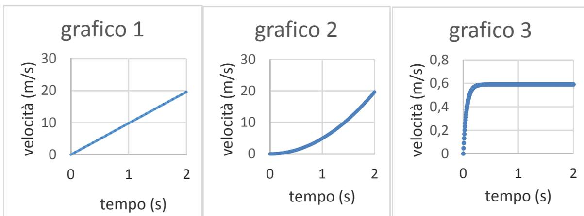
3. Calcola il valore  $v_{\text{MAX}}$  della velocità massima della barretta assumendo per essa una massa pari a 30 g, una lunghezza di 40 cm, una resistenza elettrica di  $2.0 \Omega$  (supponi trascurabile la resistenza elettrica della guida ad  $U$ ) ed un campo magnetico applicato di intensità 2.5 T.
